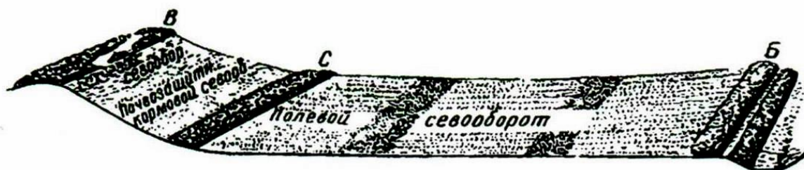
Схема размещения севооборотов и основных защитных лесных полос при вогнутом типе профиля водосборов: В – приводораздельная лесная полоса; С – водорегулирующая; Б – прибалочная
