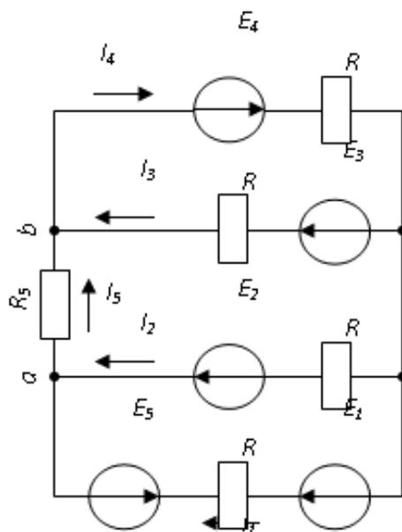
а)  $I_2 R_2 + I_3 R_3 + I_5 R_5 = E_2 + E_3$
