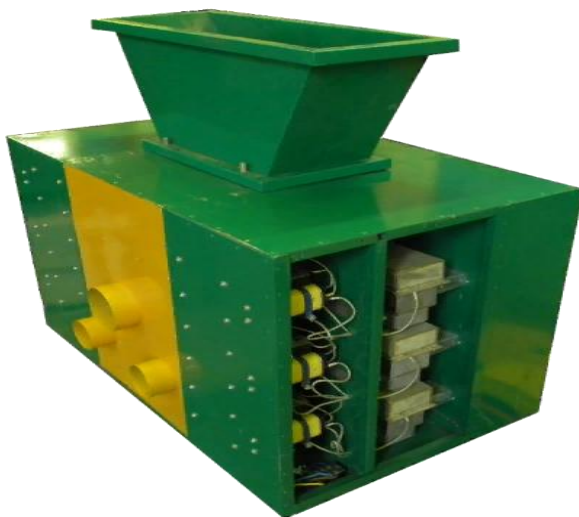
Рис. 2. Модуль СВЧ – конвективного обеззараживания зерна
