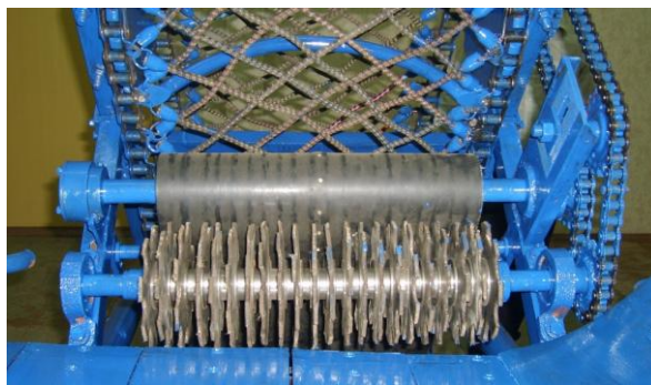
Рис. 1. Схема (а) и общий вид (б) листоотделителя капустоуборочного комбайна МКК-1
