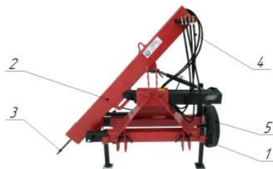
Рис. 1. Подрезчик корней ПК-1, гидравлический: 1-рама; 2-стрела; 3-нож; 4-гидрошланги; 5 - опорное колесо
