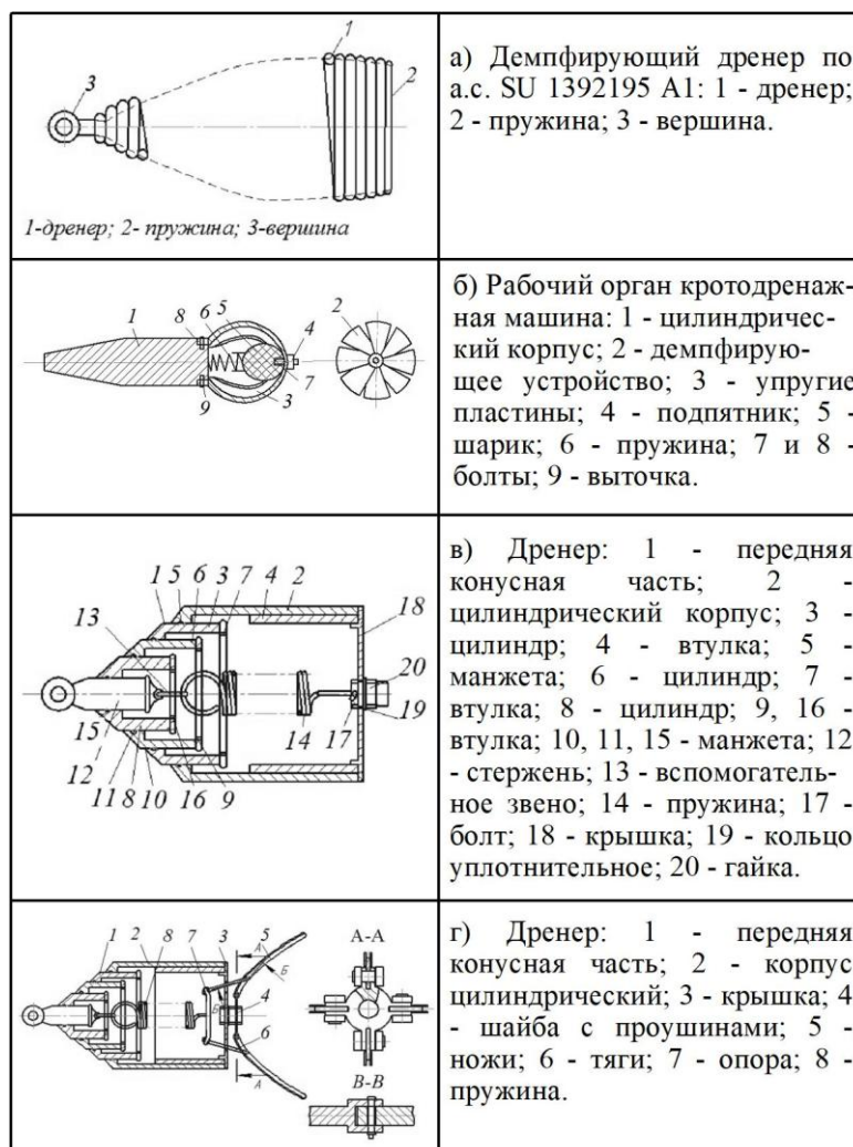
Рис. 1. Рабочие органы кротователей
