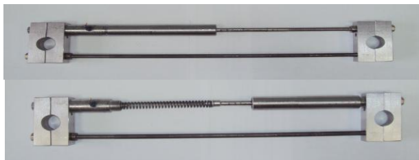
Рис.1. Пьезодатчик (в сборе – сверху; в разобранном виде – снизу)
