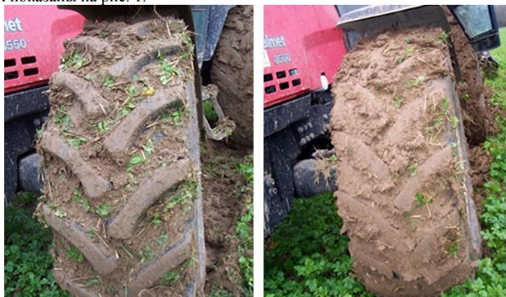
Рис. 1. Сравнение одной и той же шины с разным давлением в одинаковых условиях
