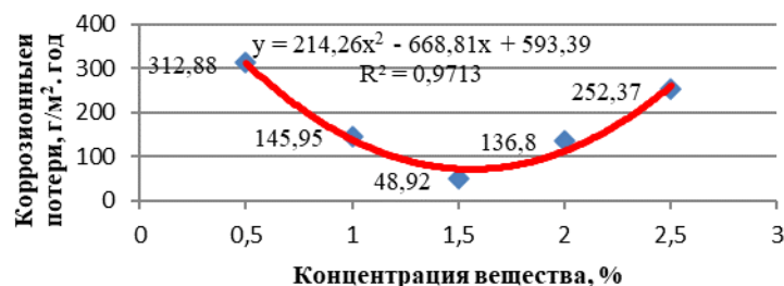
Рис. 1. Коррозионные потери алюминиевого сплава в водном растворе ПГМ «Антилед» и двойного суперфосфата
