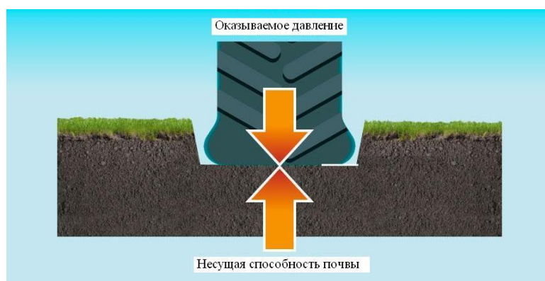
Рис. 1. Схема возникающей реакции почвы под весом трактора
