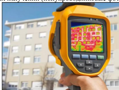
Рис. 1. Тепловые потери жилого здания
