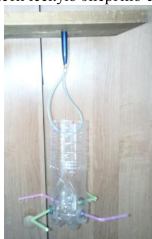
Рис.2. Модель Сегнерова колеса
