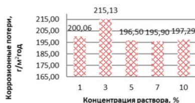
Рис. 1. Коррозионные потери стали Сталь3 в водном растворе противогололедного материала «Бионорд»
