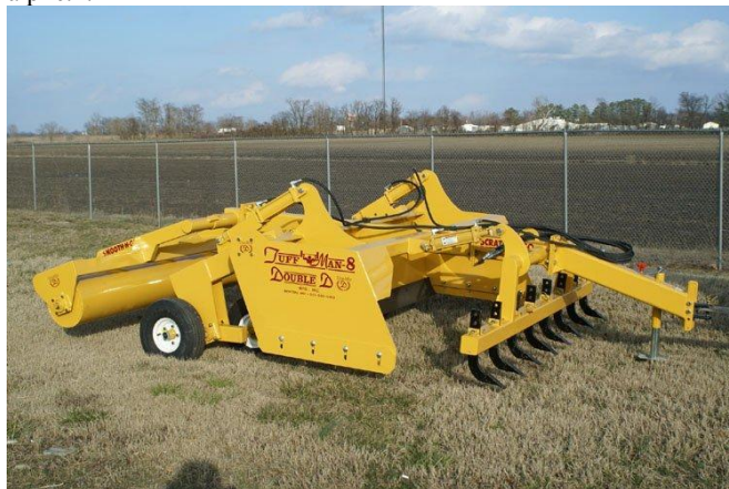
Рис. 1. Комплектация скрепера-планировщика дополнительным оборудованием
